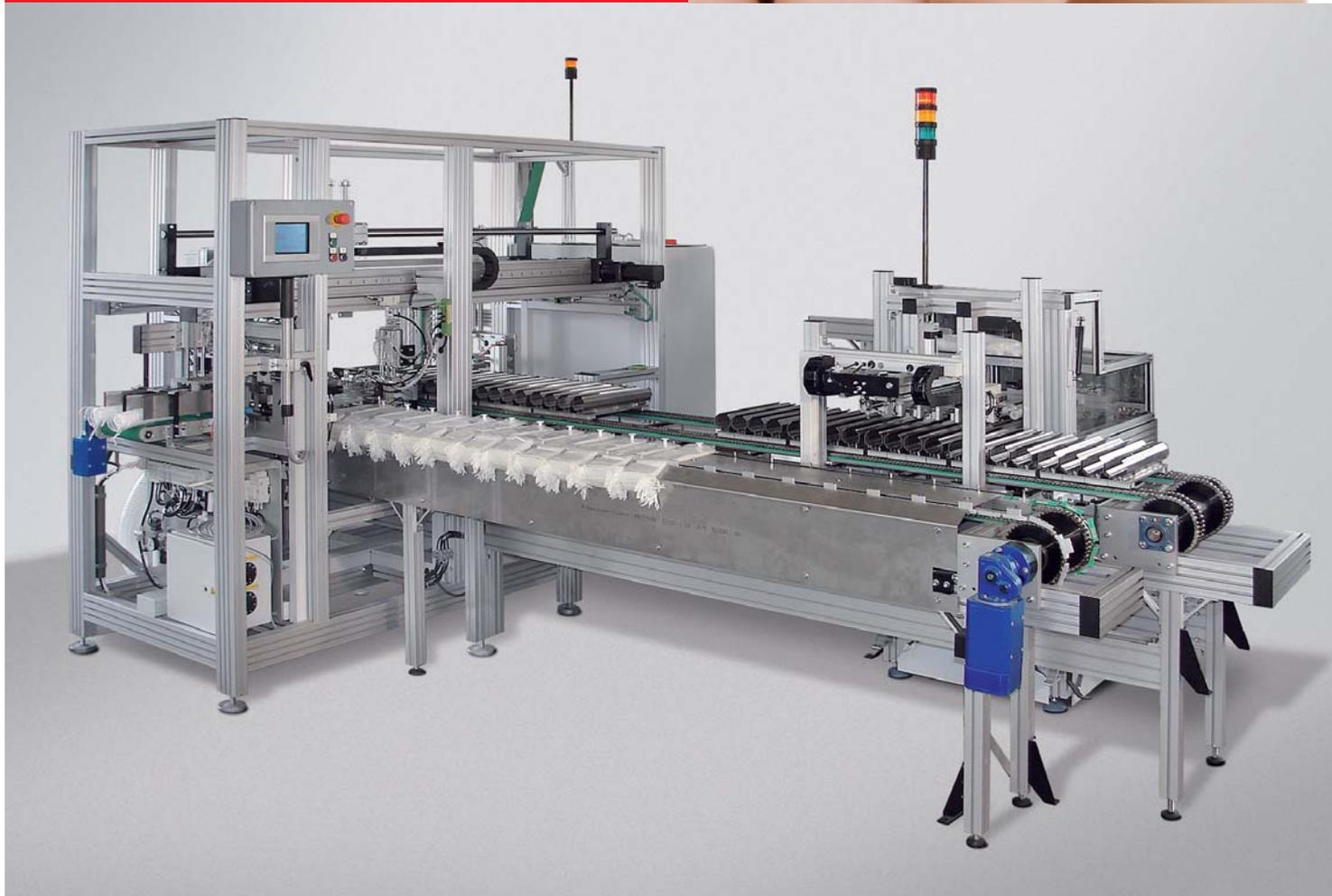
Máquina totalmente automatizada para empaquetar y embolsar discos de algodón y productos similares
